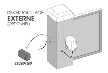
Moteur articulé avec système de déverrouillage externe!
