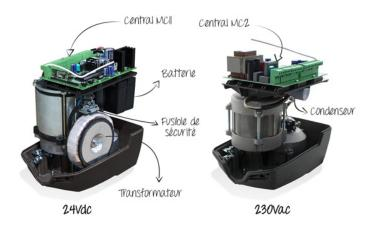
AVEC BATTERIE POUR L'OUVERTURE D'URGENCE EN CAS DE PANNE DE COURANT À 230Vdc.
