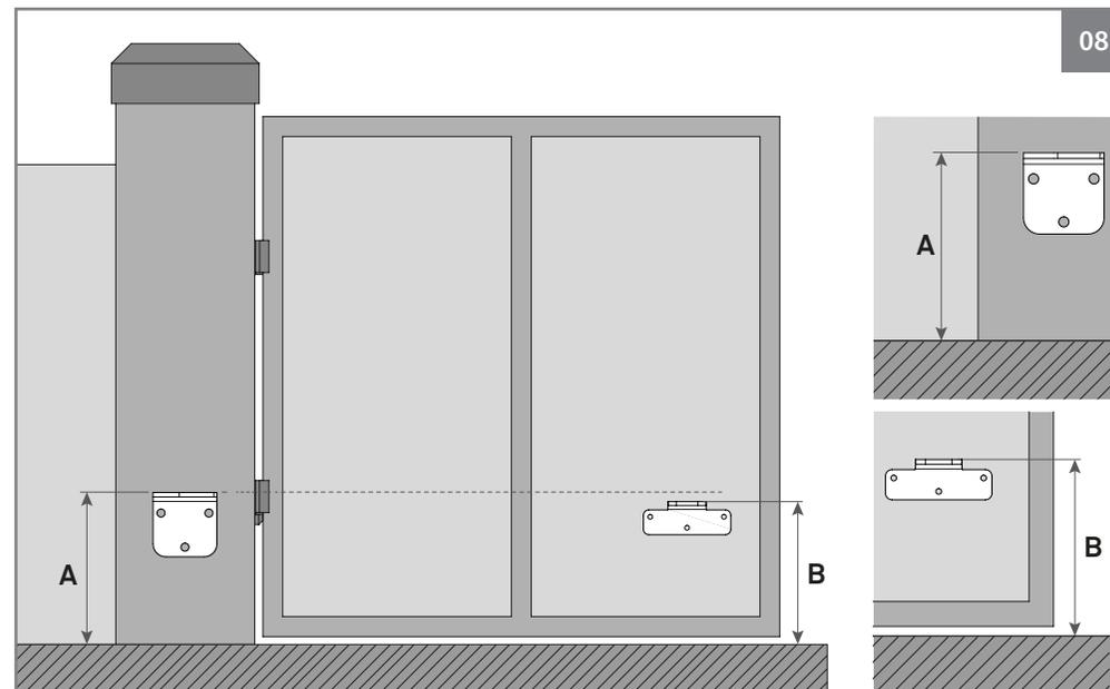
**Cota A** • Distance verticale entre le sol et la partie supérieure du support arrière.
