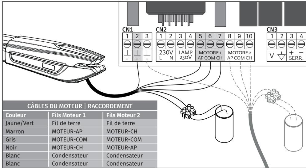
Les connexions doivent être effectuées comme indiqué ci-dessus, reliant les 6 fils du moteur aux entrées appropriées de la centrale et d'un condensateur.
