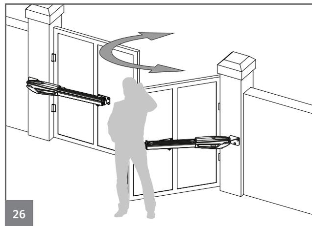
09 • Tester le portail manuellement et si nécessaire régler de nouveau les micros, selon l'indiqué dans les points précédents.
