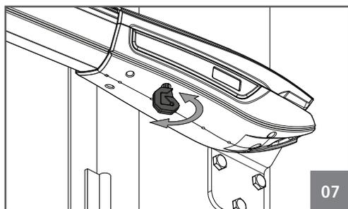
Insérer la clé de déverrouillage dans la rainure signalé sur l'image 05 (moteur installé à gauche) ou 06 (moteur installé à droite). Tourner la clé pour verrouiller ou déverrouiller le moteur.
