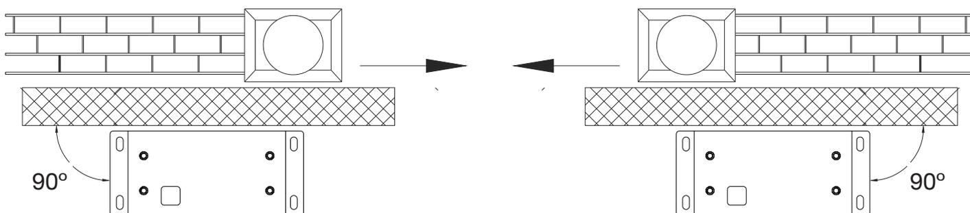
b) Visser la plaque de fixation au sol, en utilisant les vis préalablement plombés au sol, laisser un ou plusieurs tubes pour passer les câbles électriques à travers la plaque (Fig. 10 et Fig 11). En utilisant un niveau, vérifiez si la plaque est parfaitement horizontale.
