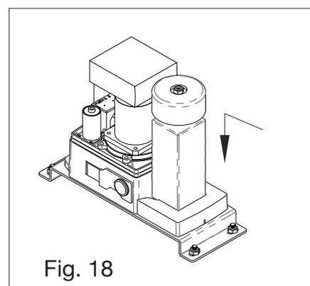
Après la fixation des composants internes, remettre les capuchons (Fig.18) et utilisez les vis pour le fixer (Fig. 19).
